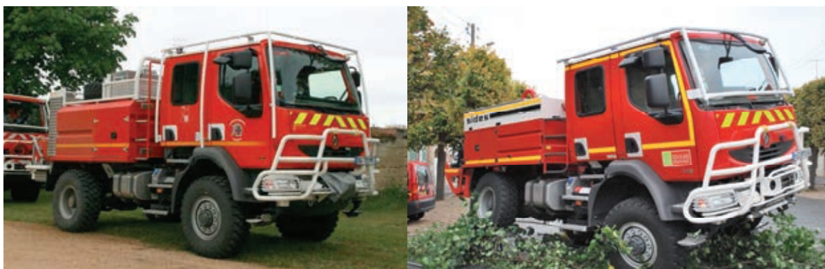
Figure 1 – Camion de sapeur-pompier 4 roues motrices type Renault Midlum
